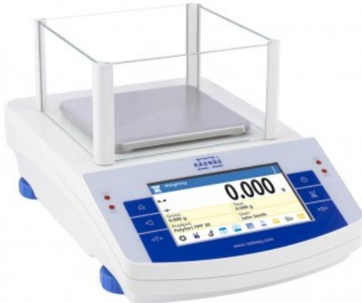
Bilancia tecnica 3000 g, precisione 0,001 g PS RADWAG modello PS 3000.X2
