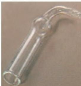
Tubi per cloruro di calcio con bolla e portagomma piegato lunghezza mm 120
