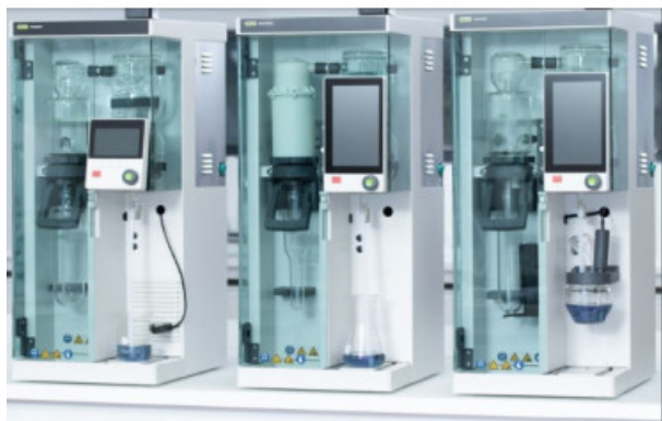
Distillatore per azoto automatico metodo Kjeldahl BUCHI modello BasicKjel
