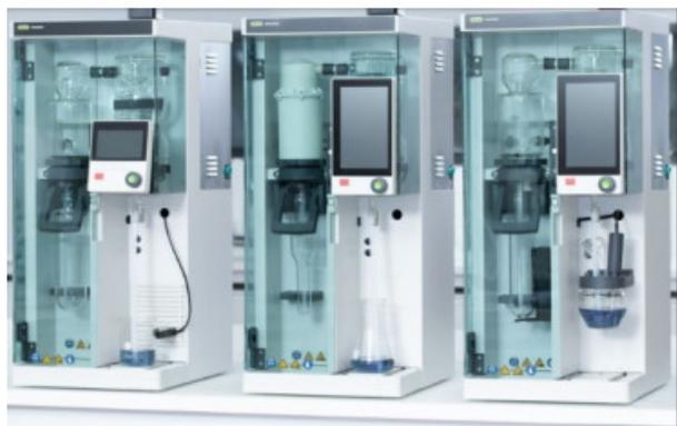
Distillatore per azoto automatico metodo Kjeldahl BUCHI modello EasyKjel
