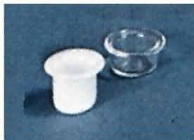
Capsula per bomba di Mahler in quarzo trasparente con bordi  $\varnothing \times H$  22X20 mm
