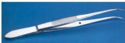
Pinza a punte sottili curve in acciaio inox rivestite in PTFE lungh. mm.140
