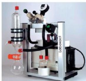
Sistema per vuoto con regolazione manuale KNF modello SEM 840
