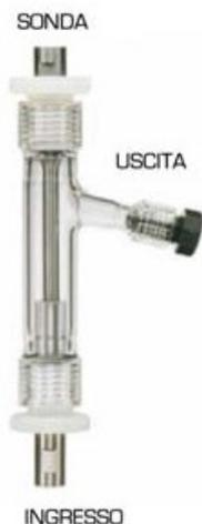
Cella a flusso continuo. Recipiente in vetro; sonda e camera di trattamento in lega Ti-6Al-4V. Si avvita al Converter. Raccomandata solo per il trattamento di campioni a bassa viscosità che non richiedono prolungate esposizioni agli ultrasuoni. Progettata per dispersione e omogeneizzazione di flussi fino a 15 litri/ora. Adatta solo per applicazioni a bassa pressione.
