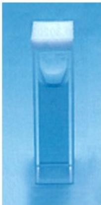
Cuvetta per spettrofotometria standard in quarzo con coperchio mm 10
