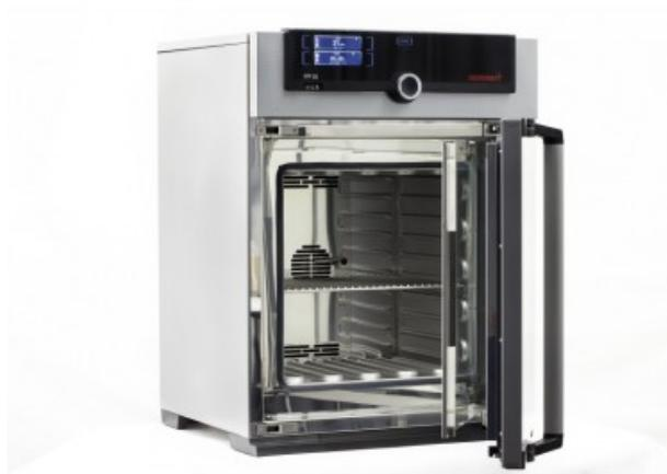
Incubatore refrigerato Peltier singolo display MEMMERT modello IPP 55
