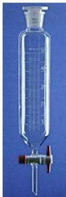
Imbuto separatore cilindrico graduato con rubinetto PTFE con tappo cono NS 29/32 ml 1000
